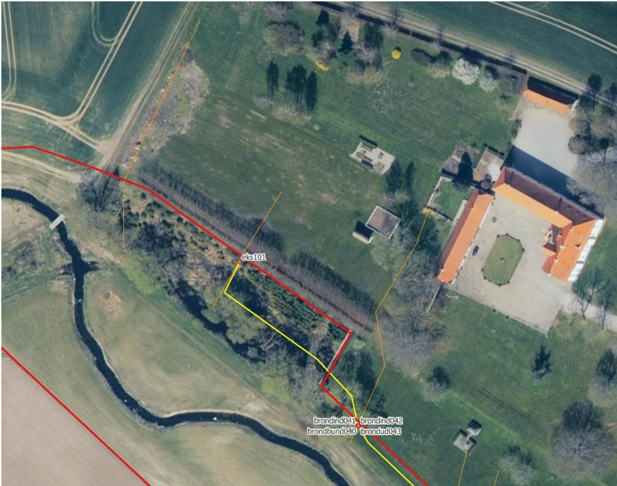
Luftfoto over udsnit af Saltøvej 61, 4700 Næstved. Gamle markdræn vist med orange, nyt markdræn vist med gul. Matrikelskel vist med rød.
