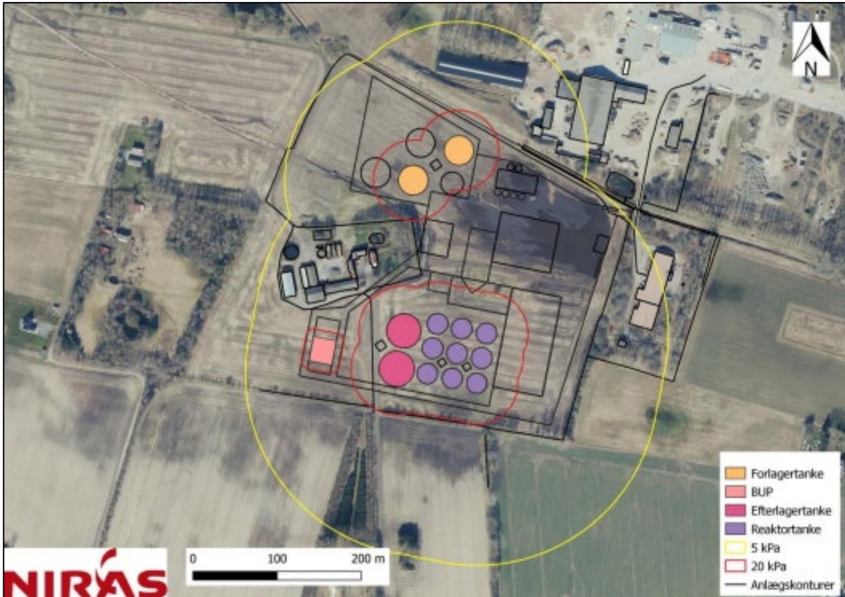
Figur 17-1: Konsoliderende trykbølge på 20kPa og 5kPa på væsentligste scenarier.
