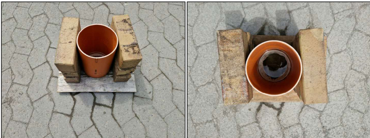
Figur 3. A: Forsøgsopstilling 1 ved forsøgsafslutning. B: Forsøgsopstilling 2 ved forsøgsafslutning. Begge forsøgsopstillinger har været tætte i forhold til rørkanten, men det kan ses, at vandet også er infiltreret horisontalt i fugerne udenfor rørene. Begge fra Vemmelev.
