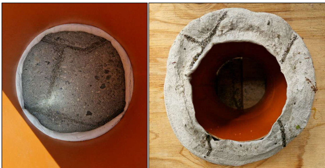
Figur 1. A: Billede visende fugesamlinger mellem SF-sten i bunden af røret før forsøgsstart. B: Billede af sanitetskit set nedefra efter forsøgsafslutning. Begge i Vemmelev.
