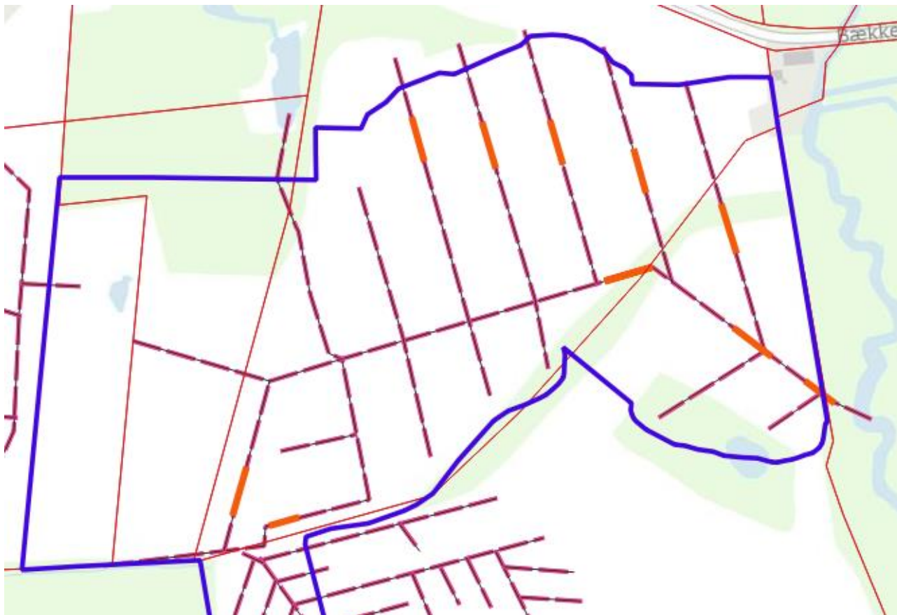
Kort 3.1.6.1: Kortet viser hvor drænsystemet skal sløjfes. Sløjfningernes placering er markeret med orange. Projektområdet er markeret med blå og drænsystem med stiplede rødt.
