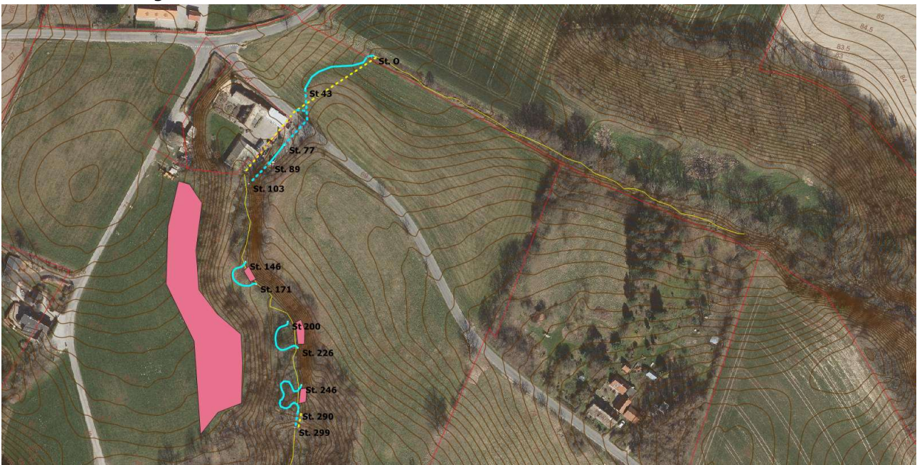
Kort 2. Station 0 til 299. Gul linje eksisterende åbent vandløb, stiplet gul linje eksisterende rør Ø 0,5 meter. Blå linje projekteret åbent vandløb, stiplet blå linje projekteret rør Ø 0,8 m, sidedræn Ø 0,2 m. Lyserød polygon placering af opgravet jord
