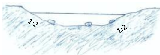
Figur 3-2: Principskitse for vandløbsprofilen (trapezprofil) for lige strækninger af det nye forløb.
