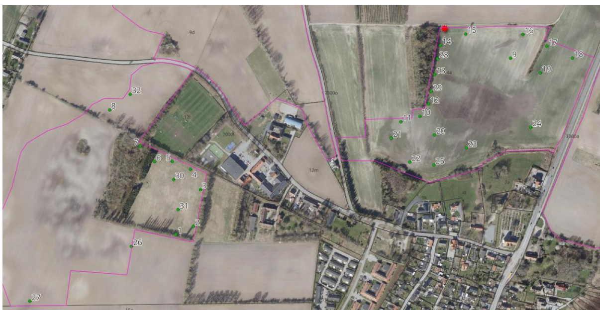
Figur 5-1: Placering af geotekniske borer; borer indtil 2 m (grøn markering), boring til 4 m (rød markering (boring nr. 33)).
