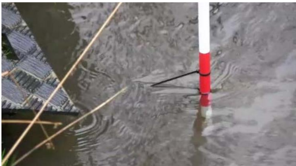
Figur 1: En landmålerstok med afsatte mærker for den ønskede vandstand er et simpelt og godt redskab til at sikre sig, at vandstanden holdes på det ønskede niveau (Kilde: Aqua DTU)
