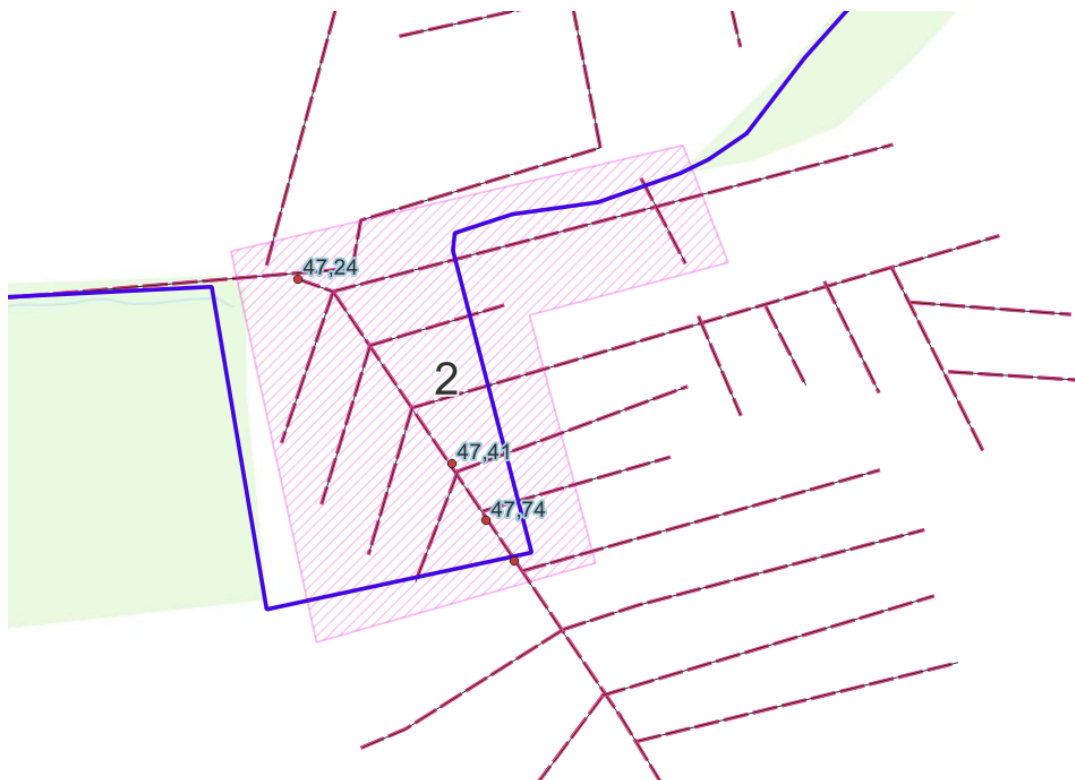
Kort 4.4.1 Kort over undersøgelsesområde 2 med målte drænkoter. (dræn er markeret med rød stiplede linje, projektgrænse med blå og drænkoter med rød prik)
