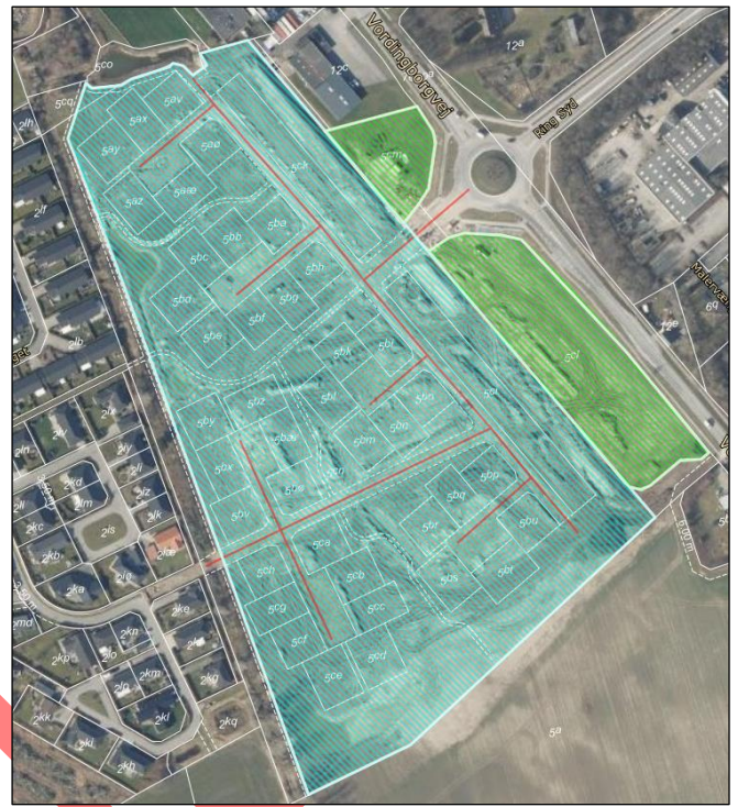
Figur 9.2. Kvædevænget optages i spildevandsplanen som spildevandskloakeret (blåt skraverede område) og Ved Mejeriet optages som separatkloakeres (grønt skraverede område).
