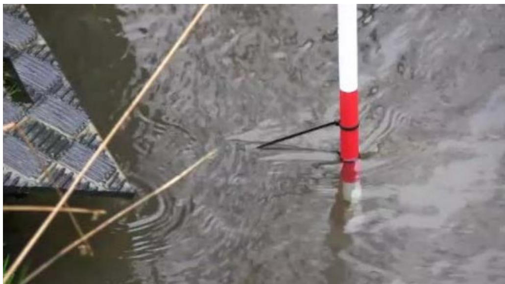
Figur 7.1: En landmålerstok med afsatte mærker for den ønskede vandstand er et simpelt og godt redskab til at sikre sig, at vandstanden holdes på det ønskede niveau (Kilde: Aqua DTU)
