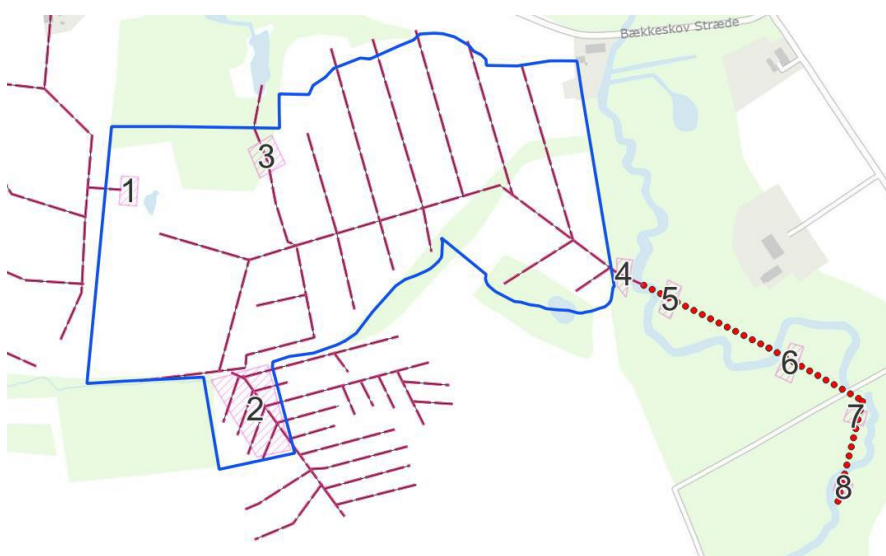
Oversigtskort, der viser placeringen af i alt 8 undersøgelsesområder. Projektområdet er markeret med blå, dræn med stiplet rød og omtrentlig placering af hoveddræn, der afleder til Krobæk, med prikket rød. Fra ansøgningsmaterialet.
