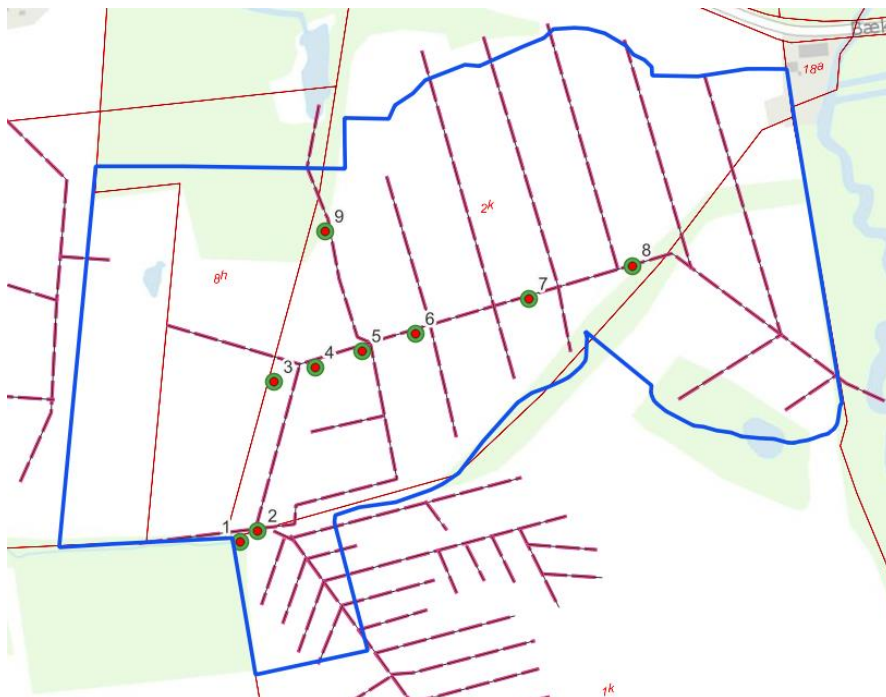
Oversigtskort, der viser placeringen af i alt 9 brønde indenfor projektområdet, der sløjfes. Projektområdet er markeret med blå, brønde er angivet grøn/rød prik, og drænsystem er angivet med stiplet rød. Fra ansøgningsmaterialet.
