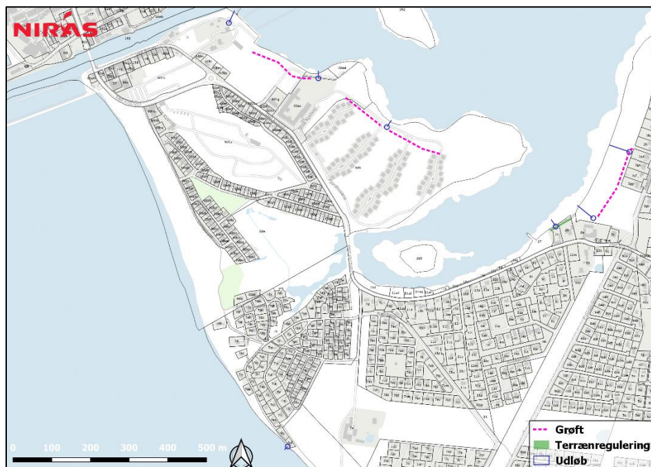
Figur 2.1: Oversigtskort med afværgeanlæg til håndtering af skybrudsvand efter højvandsbeskyttelsens opførelse.
