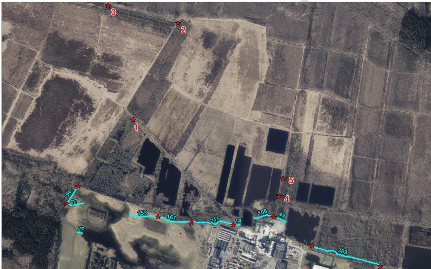
Kortbilag 4. Vedligeholdelsespligtige omløb og overløb i Holmegaard Mose Længdeangivelse (blåt) og vedligeholdelsespunkter (rødt)
