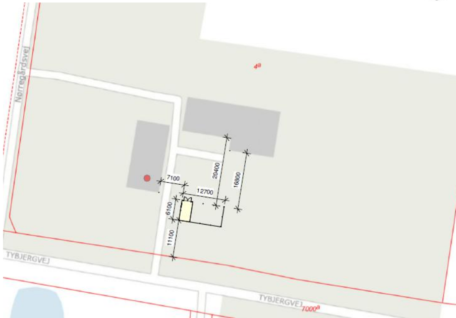
Situationsplan med indtegning af den nye garage vist med sort streg. Det integrerede redskabsskur er vist med gult. Fra ansøgningsmaterialet.
