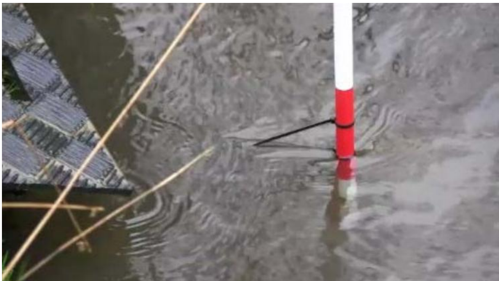
Figur 8.1: En landmålerstok med afsatte mærker for den ønskede vandstand er et simpelt og godt redskab til at sikre sig, at vandstanden holdes på det ønskede niveau (Kilde: Aqua DTU)
