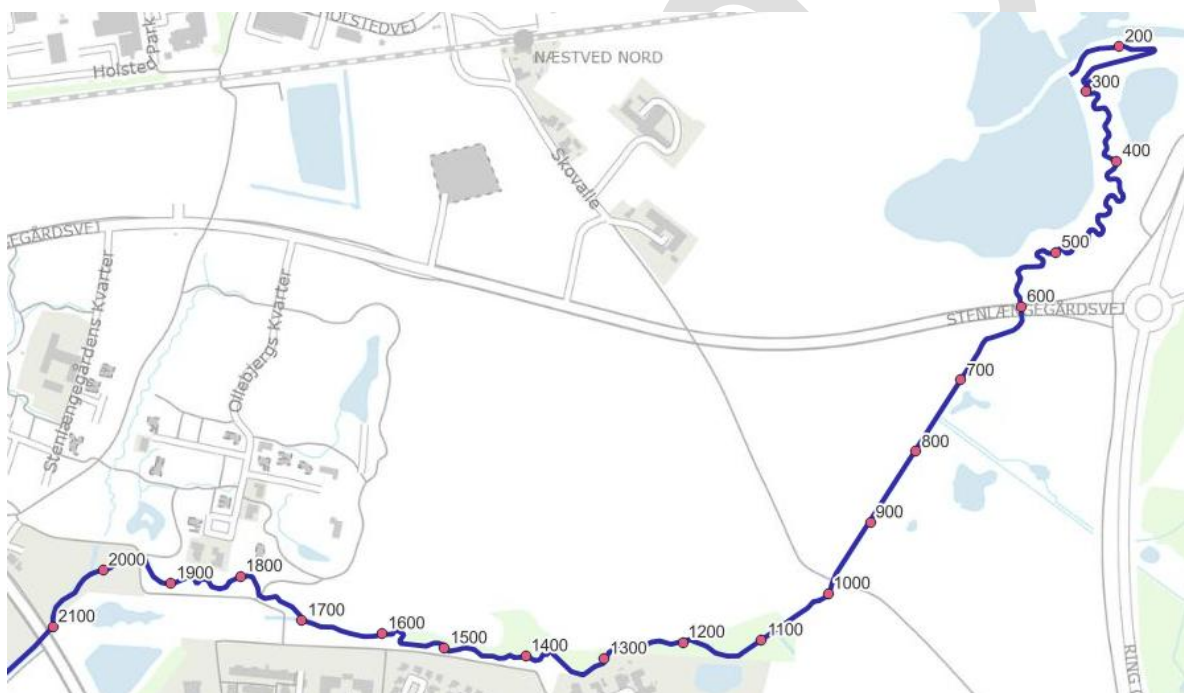
Kort 2.1.1: Stationeringskort der viser placeringen af stationerne fra st. 200 til st. 2100. Stationeringen er ikke kalibreret med gældende regulativ, men stationeringen mellem st. 600 og st. 1000 er retvisende.
