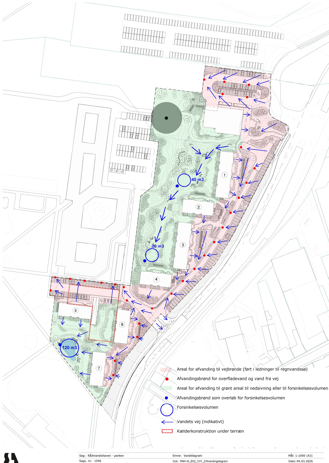
Figur 2-7. Plan for regnvandsafledning i projektområdet (SLA / Artelia, 2026)
