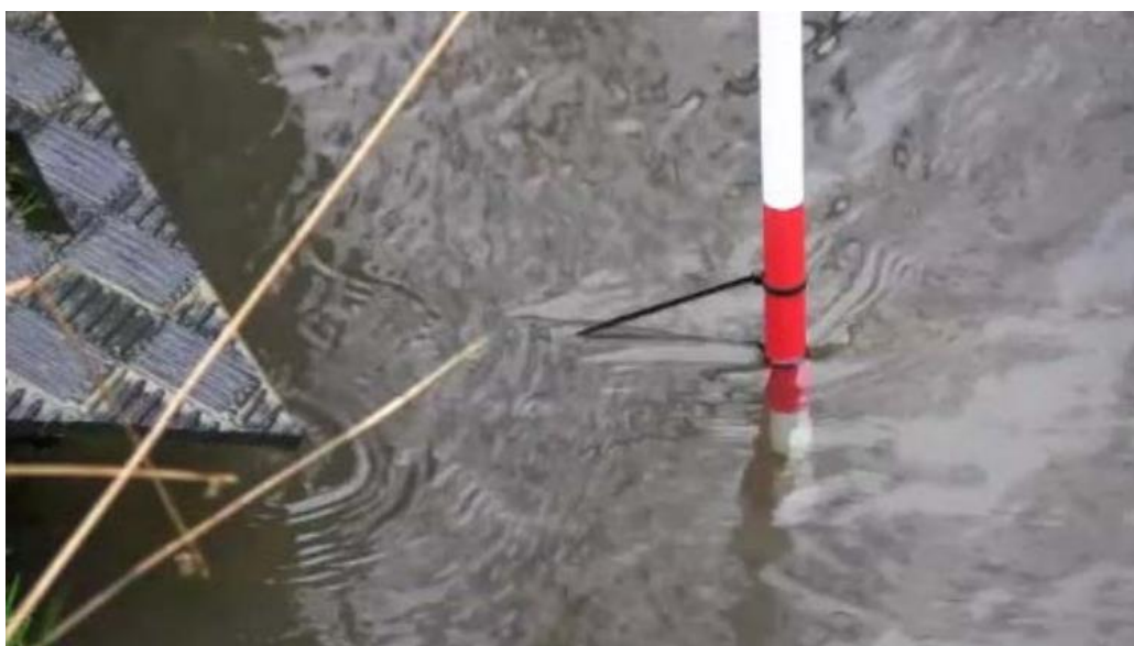
Figur 6.1: En landmålerstok med afsatte mærker for den ønskede vandstand er et simpelt og godt redskab til at sikre sig, at vandstanden holdes på det ønskede niveau (Kilde: Aqua DTU)
