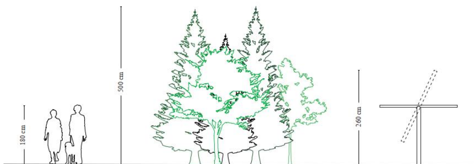
Figur 3 Princip for afskærmende beplantning omkring solceller.
