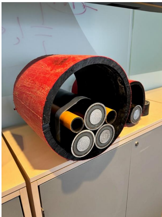
Foto 1: Beskyttelsesrør Ø280 med elkabler
