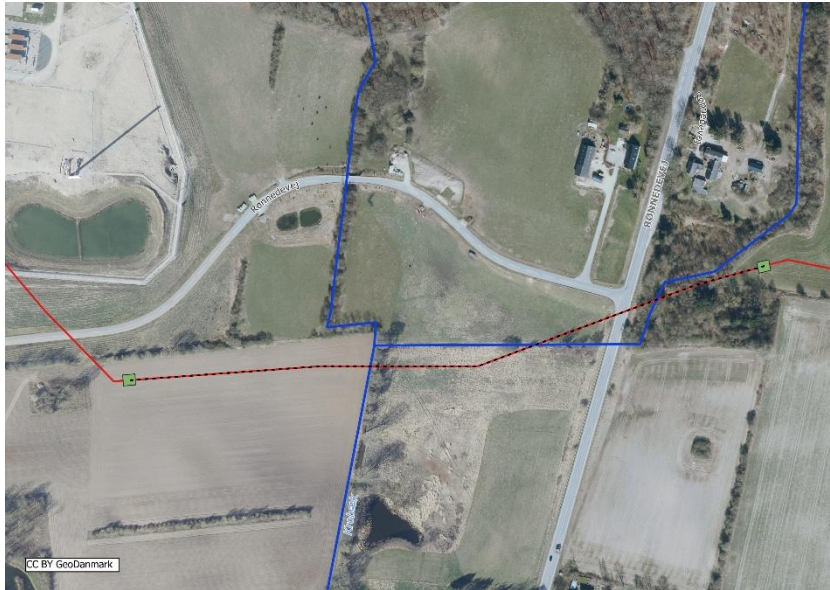
Kort 2: Detajlkort med angivelse ledningstracé (rød linje) samt underboring (sort stiple linje), arealer for boregruber (grønne felter) samt vandløb (blå linje) på 2025 luftfoto.
