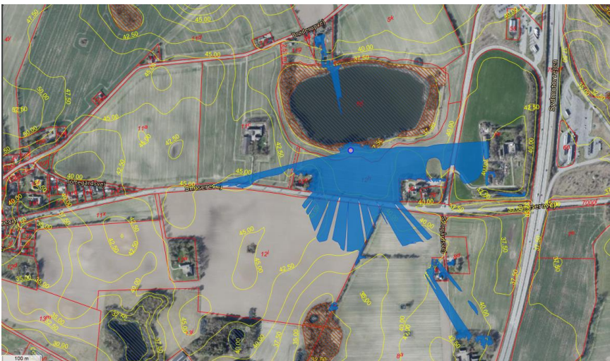
Figur 8. Synlighedsberegning af et punkt 2,6 m over terrænen ved buffertanken fra en øjenhøjde i 1,7 m i en afstand af indtil 1 km. Bemærk at synligheden også vises 1,7 m oven på bygninger, beplantninger mm.
