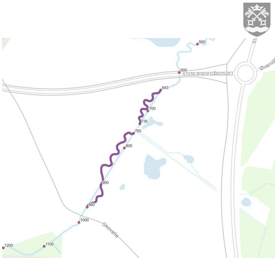
Figur 4 – genslyngning på kort. Eksisterende vandløbstrace er vist med blå polylinje og fremtidigt vandløbstrace med lilla. Vandløbet forlænges mellem st. 643 og st. 960 (317) med ca. 100 m.
