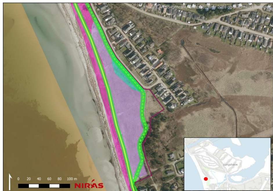
Figur 4.13: Digets beregnede fodaftryk på Enø Strand mellem Lungskyst 19 og Strandvejen 21A (rød prik på oversigtskort).
