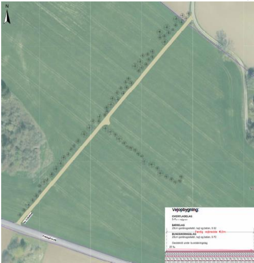
Ansøgt vejforløb og beskrivelse af opbygningen af bundsikring, bærelag og overfladelag som vist i ansøgningsmaterialet.
