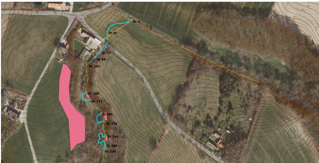
Kort 2. Station 0 til 299. Gul linje eksisterende åbent vandløb, stiplet gul linje eksisterende rør Ø 0,5 meter. Blå linje projekteret åbent vandløb, stiplet blå linje projekteret rør Ø 0,8 m, sidedræn Ø 0,2 m. Lyserød polygon placering af opgravet jord
